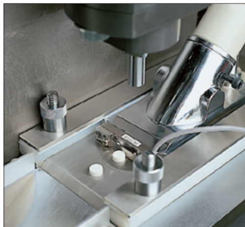
検出センサ取付状態
