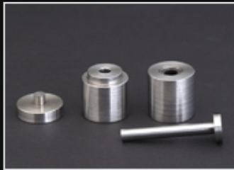
φ5mmのサンプルセル(写真)は臼の容積が約0.3mL、φ3mmのセルでは約0.1mLとなるため、わずか十数mgの極微量のサンプルで十分に試験が行えます。また、上枠はリニアベアリングをはめ込んだ上パンチガイドによって常に支持されるため非常にスムーズに動作し、荷重を粉体層に確実に伝達します。小型のサンプルセルにありがちな杵曲がりなどの事故の心配もありません。
