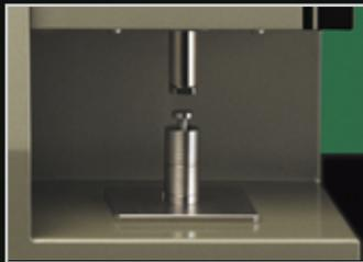
加圧ロッドは標準仕様で最大100kgf、オプション仕様では200kgfの加圧力を有しています。φ3mmのサンプルセルを用いる場合、これはφ11mmのサンプルセルにおよそ3tonfの荷重を加えるのと同等の能力となります(200kgf仕様)。また、加圧ロッド内部には近接センサーが内蔵されており、これまで判断が難しかった圧縮開始のタイミングを正確に決定できます。
