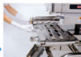
コンベアフレーム抜き出し
